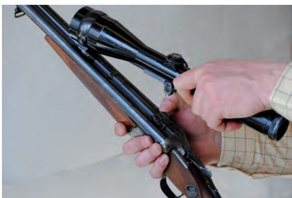
Pikajalka on hyvä ratkaisu, kun aseessa käytetään useita tähtäimiä.
