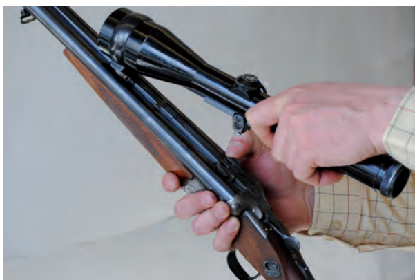
Perinteinen kiikaritähäimen hakasjalkakiinnitys drillingissä.
