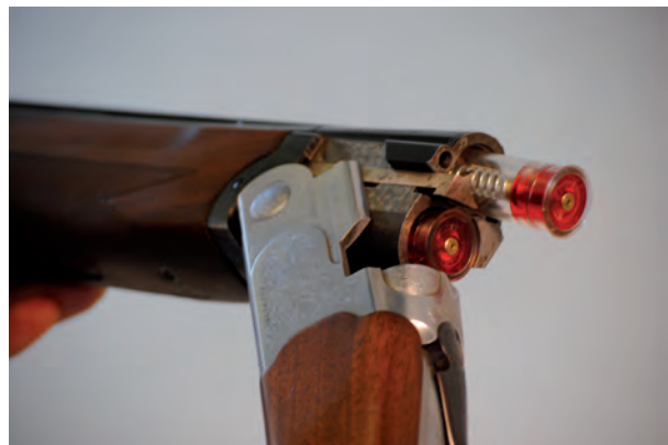
Klikkipatruunat säästävät aseiden nallipiikkejä kuivaharjoittelussa.
